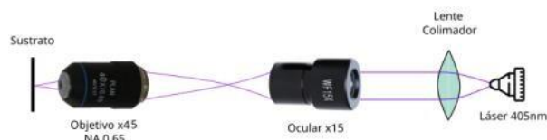
Fig. 2 Esquemático de la trayectoria óptica del haz
