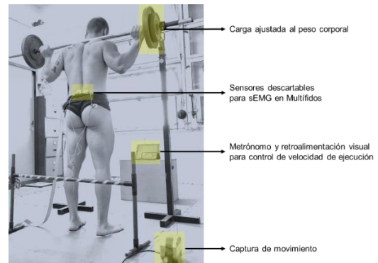
Fig. 1. Setup experimental. Disposición espacial de los instrumentos de medición.
