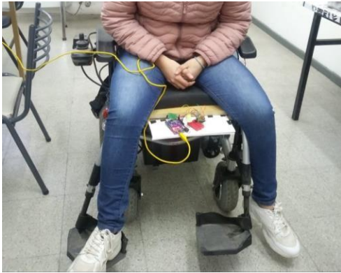
Figura 3: Prototipo del asiento para prevención de escaras en una silla de ruedas.
